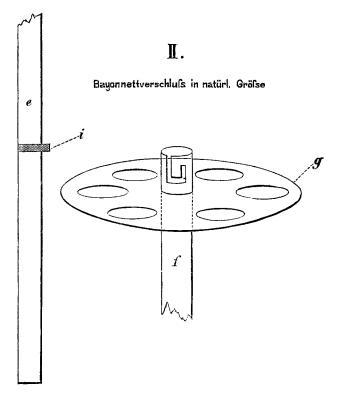
Recipientenhalters wird der Bayonnetteverschluss geöffnet und der daran hängende Deckel entfernt.
